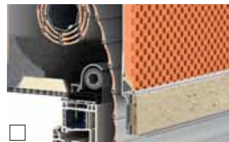
Verlängerbare Außenschürze (um den oberen Blendrahmen weitestgehend zu verblenden)
